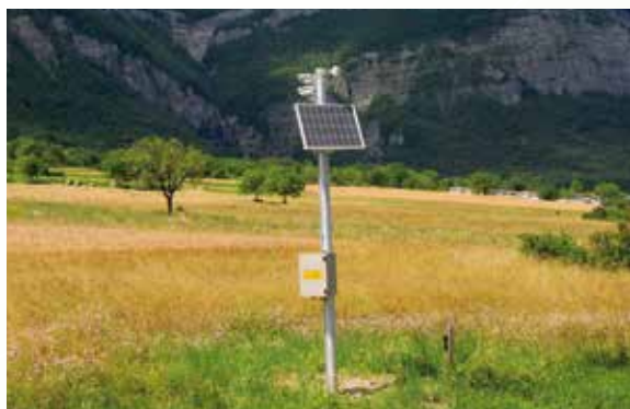
Des mâts avec à leur tête des capteurs infrarouges et caméras pouvant détecter des animaux.
