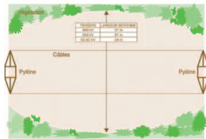
Largeurs moyennes des zones de servitudes des ouvrages de transport électrique. Vue de dessus d'une portée.
