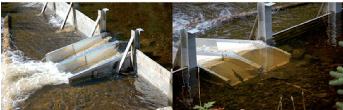
Figure 39 : Exemple de compteur à résistivité utilisé en rivière (Schéma : Loughs Agency (2016) ; Photo : InStream Fisheries Research).
