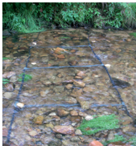
Figure 5 : À gauche : schéma d'équipement de la buse OH 448 à l'aide d'antennes RFID fixes. Les encadrés A1 et A2 représentent les antennes RFID fixes installées en amont de la buse. À droite : illustration d'une antenne installée dans la Durolle.
