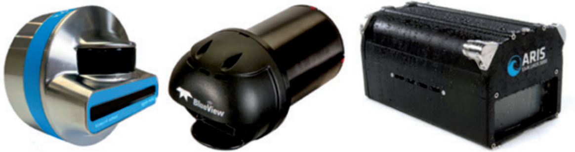
Figure 38 : Exemples de caméras acoustiques utilisées pour les suivis de flux migratoires piscicoles. De gauche à droite, Oculus M1200d, Blue view M900-2250, Aris explorer 3000 Source : Soundmetrcs, Subsea.
