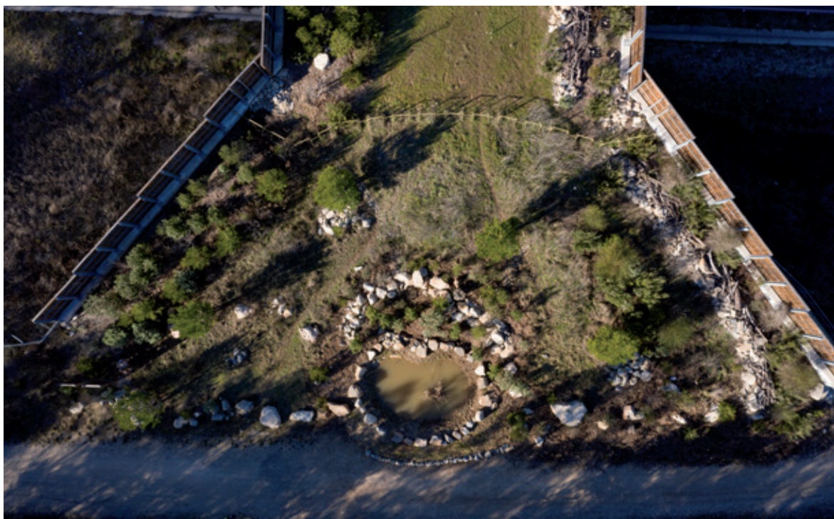
Figure 24 : Enrochements réalisés autour de la mare afin de préserver du passage des Sangliers. ©Photothèque VINCI Autoroutes.
