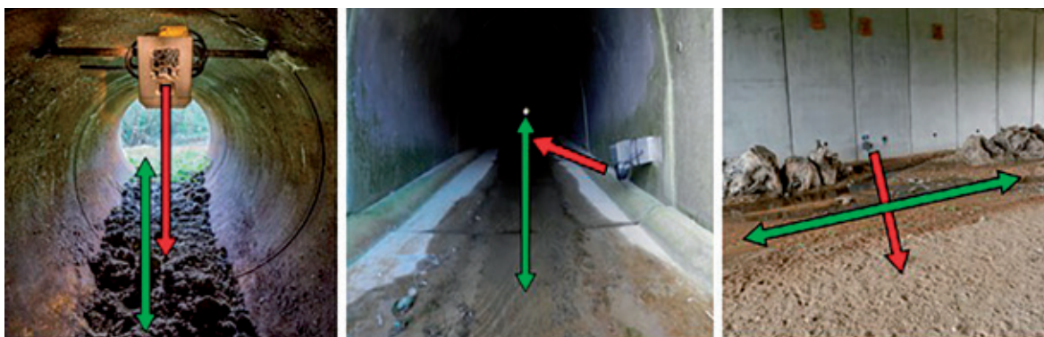
Figure 57 : Orientations possibles des pièges photographiques (en rouge) par rapport aux cheminements visés (en vert). a) positionnement « au-dessus », dans l'axe; b) positionnement « en biais », sur un côté; c) positionnement « à la perpendiculaire » du cheminement.
